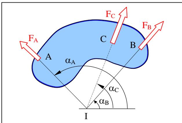
Soit I le point d'intersection des droites d'action des deux forces  $\vec{F}_A$  et  $\vec{F}_B$  dont les directions sont connues.
