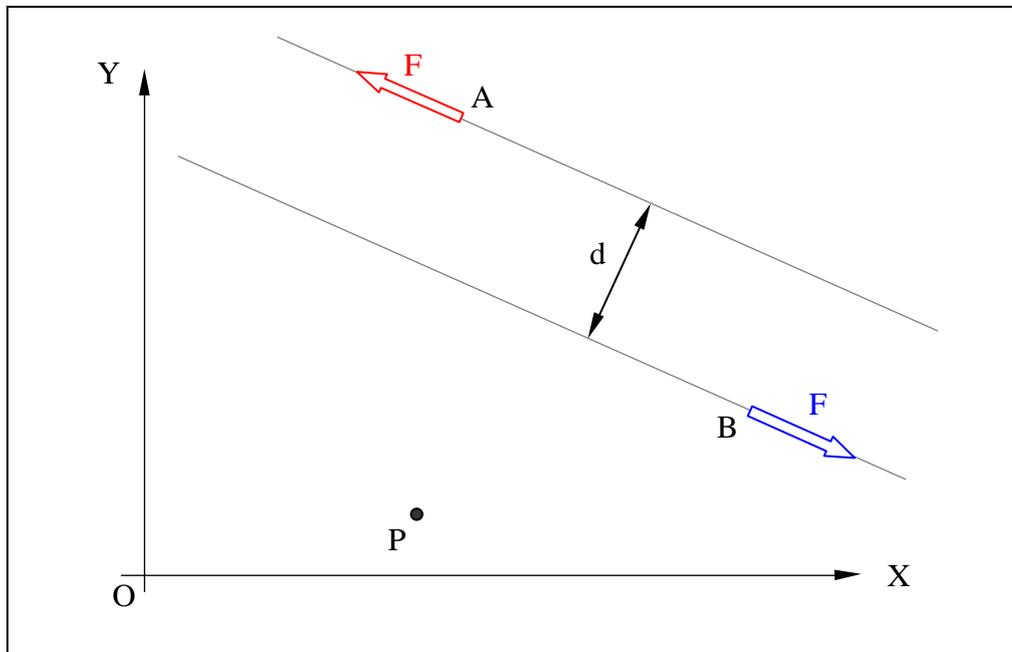
Dans le cas où la résultante est nulle, le moment résultant en un point est indépendant du point choisi. On se propose de le vérifier rapidement, en considérant les bras de levier des forces.
